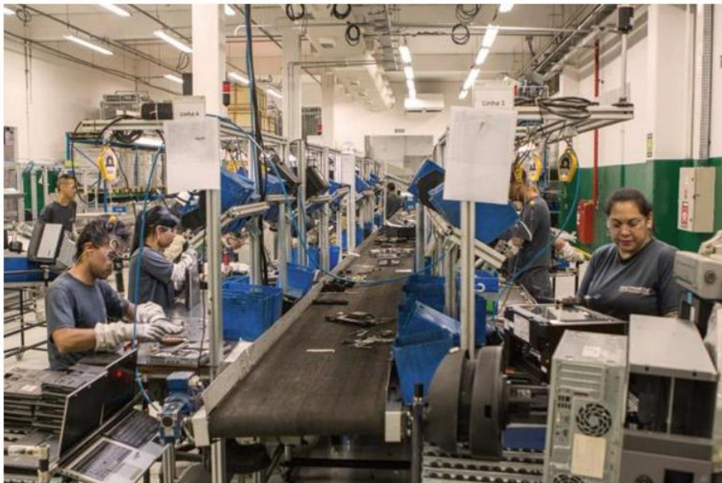
Figura 11: Linha de desmontagem de REE da Organização 2
